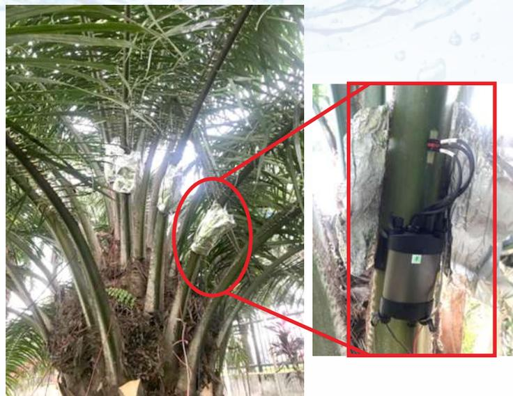
Gambar 1. Pemasangan alat sap flow meter pada pelepah tanaman kelapa sawit
