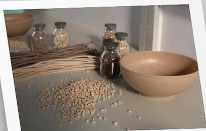
**Pembuatan produk akhir berupa mangkok** menggunakan teknik injection moulding dengan 2 variasi, yaitu bijih bioplastik 30% dan 50%. Proses pencetakan menggunakan mesin injection moulding dengan tekanan 100 ton.
