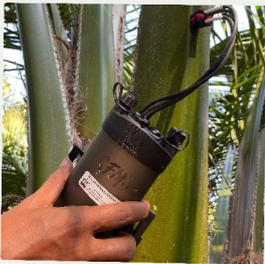
Pengukuran transpirasi menggunakan alat SFM (atas) dan pengukuran iklim mikro di bawah kanopi sawit (bawah)
