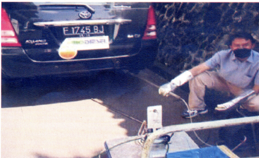
Pengujian Emisi pada kendaraan yang menggunakan biodiesel
