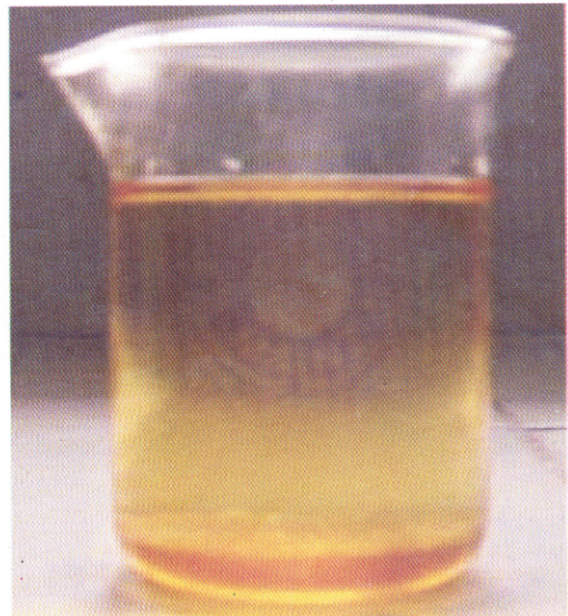
Hasil Transesterifikasi dan Proses Pengendapan dengan lapisan bawah Gliserol dan lapisan atas Metil Ester
